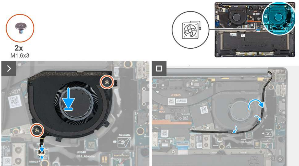
Figure 28. Installing the left fan
